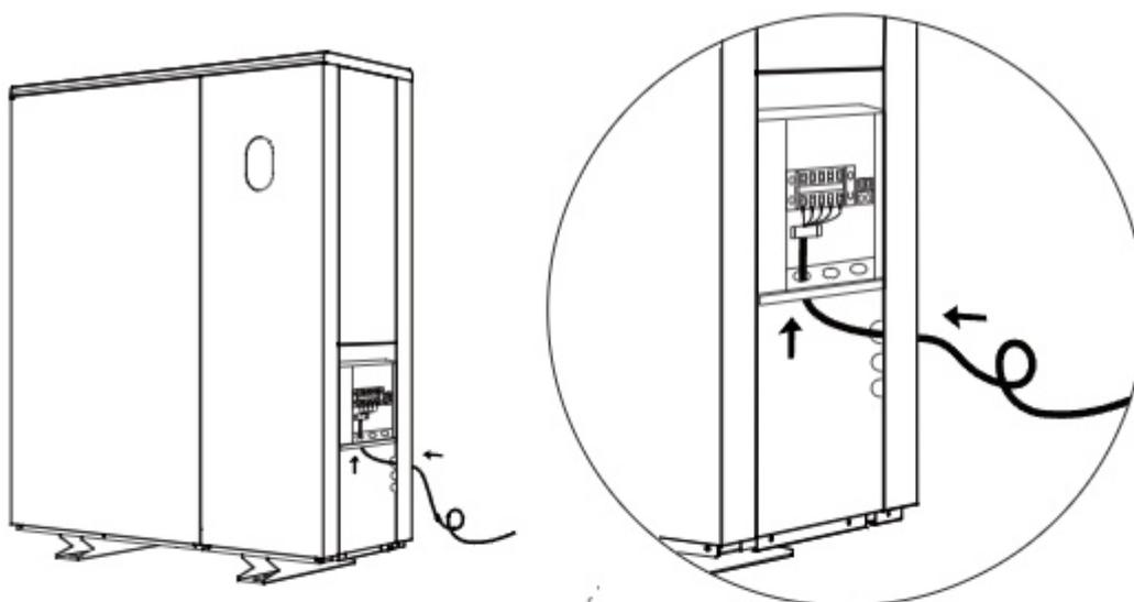
④ Установите клеммную крышку и сервисную пластину по порядку.
