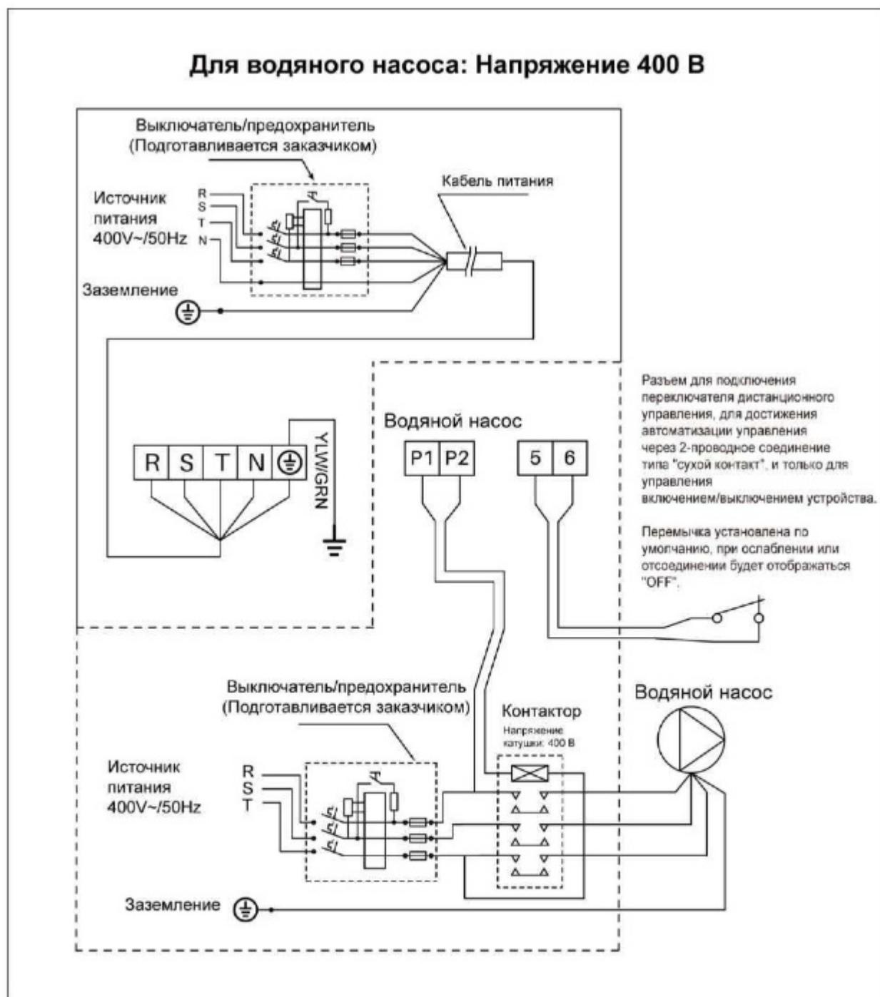
**Параллельное подключение с таймером фильтрации**
