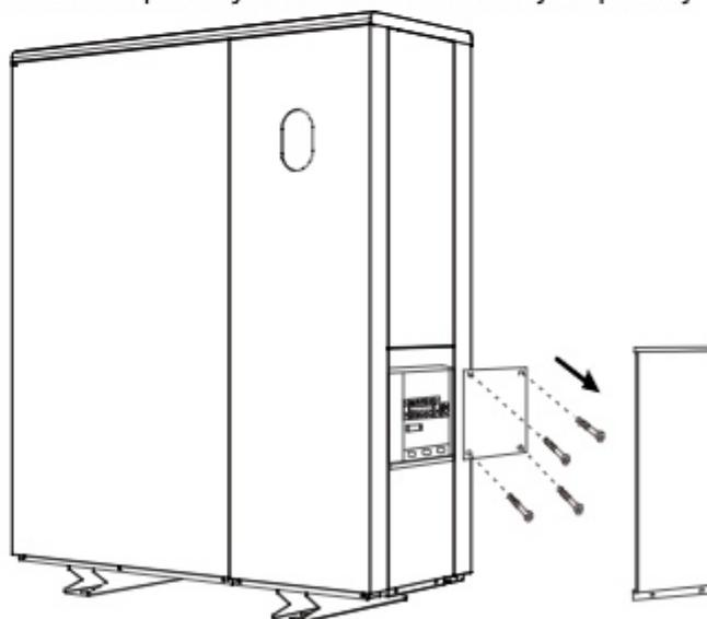
③ Подключите шнур питания в соответствии со схемой.
