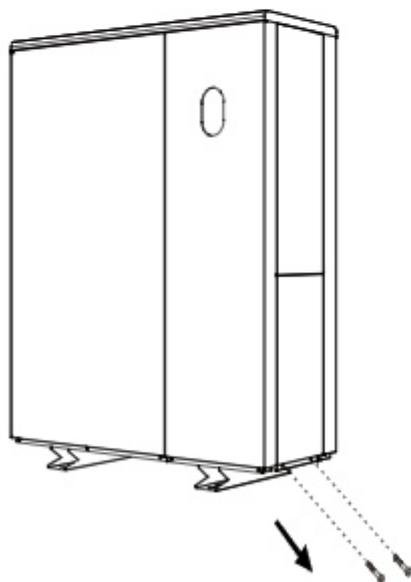
② Снимите сервисную панель и клеммную крышку.
