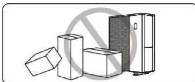
1.4.4. Не вставляйте посторонние предметы в отверстия для входа и выхода воздуха. В противном случае это может привести к снижению производительности теплового насоса или даже к его остановке.
