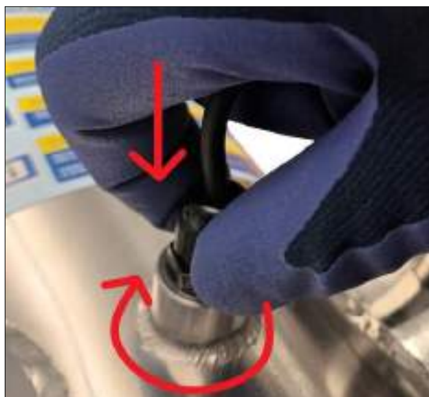
д) Завинтите крышку, удерживая кабель прижатым к нижней части втулки.
