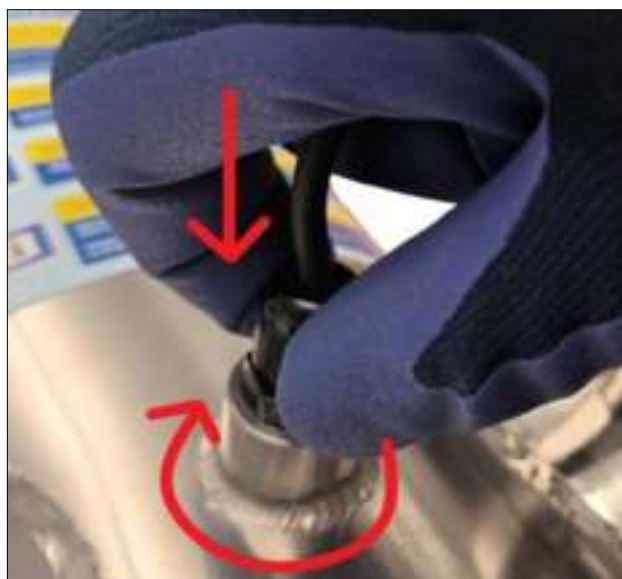
д) Завинтите крышку, удерживая кабель прижатым к нижней части втулки.
