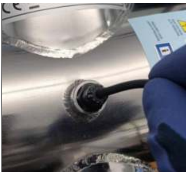
с) Убедитесь, что сенсорный элемент (на конце кабеля) соприкасается с нижней частью втулки
