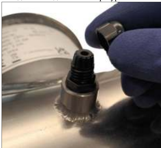
а) Снимите колпачок кабельного ввода
