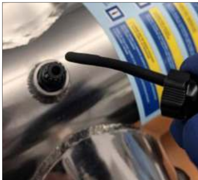
б) Вставьте кабель сначала в колпачок, а затем в кабельный ввод
