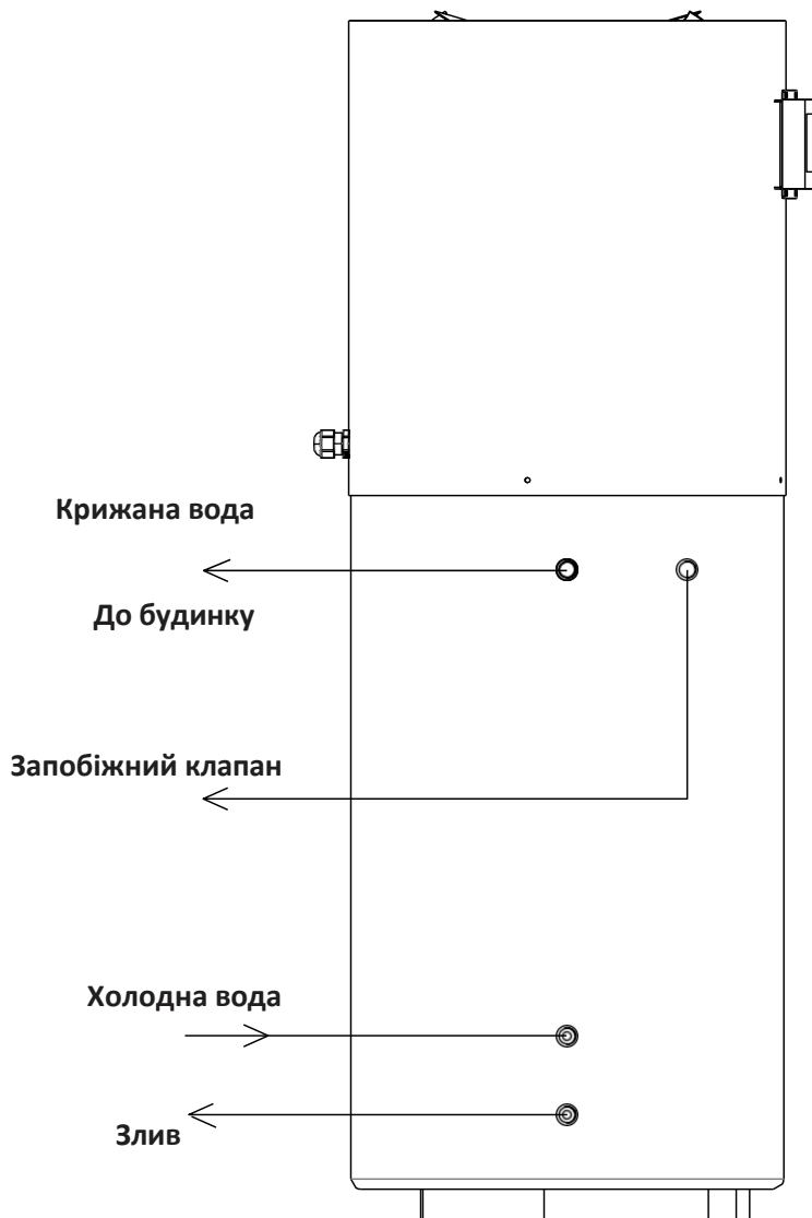
Малюнок 4. Детальна схема водопроводу
