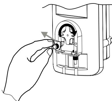
**3)** Разрезать две фиксирующие стяжки черного света с каждой стороны патрубка. Патрубок окажется высвобожден, и его можно утилизировать.
