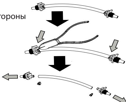
**4)** Соединить новый патрубок с местами крепления. Затянуть фиксирующие стяжки, чтобы обеспечить герметичность места соединения. Надежно закрепив стяжки, обрезать и утилизировать их лишние части.
