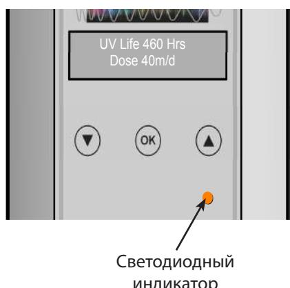
После замены УФ-лампы следует сбросить таймер срока службы лампы на 9000 часов. В режиме индикации срока службы УФ-лампы нажмите и отпустите кнопку OK, чтобы задать Reset UV Lamp (Сброс УФ-лампы), а затем сразу нажмите и удерживайте кнопку OK до тех пока, пока на дисплее не появится надпись SAVED (СОХРАНЕНО), и тогда отпустите кнопку OK. На дисплее появится надпись UV Life 9000 Hrs (Срок службы УФ-лампы 9000 ч). 'Обратите внимание, что сбой электропитания не влияет на отсчет срока службы лампы.
