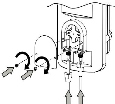
**6)** Установить всасывающий и выпускной патрубки обратно на соединительные крышки и повернуть их, чтобы закрепить трубчатые соединения. Установить прозрачную крышку на место и закрепить ее при помощи винтов.
